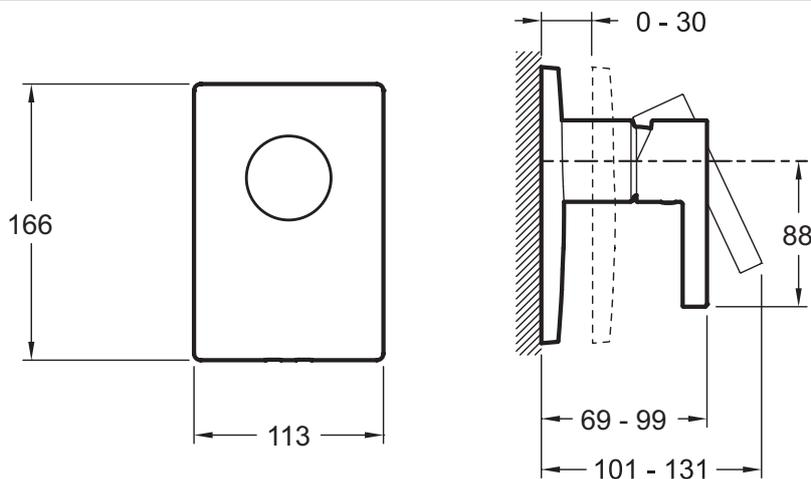
Спецификация продукта : Встраиваемый смеситель на 1 выход, E98711. Коллекция : STILLNESS. ВЕС : 1.5 кг. МАТЕРИАЛ : N/A. ТИП УСТАНОВКИ : Встраиваемые. TYPE D'ACCESSOIRE : 0. AVEC OU SANS ROBINETTERIE : 0. MITIGEUR : 0. TYPOLOGIE DE ROBINETTERIE DE DOUCHE : 0. FORME DE LA DOUCHE DE TÊTE : 0. INVERSEUR : 0. TYPE DE FLEXIBLE : 0. Комплект для установки Modulo 98699D.
